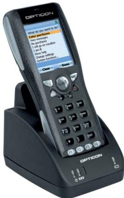
Das OPH 1005 ist ein sehr zuverlässiges, elegantes und gleichzeitig auch robustes mobiles Laserterminal. Mit einem Datenspeicher von 128 MB (NAND Flash) und 4 MB Flash ROM und 4 MB SRAM ist es auch für Anwendungen mit größeren Datenmengen hervorragend geeignet.
